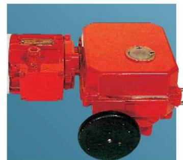
Электроприводы неполноповоротные типа ПК и В-ПК применяются для дистанционного управления однооборотной запорной арматурой (шаровыми кранами, дисковыми затворами и другими механизмами, требующими поворота рабочего органа на угол 40 ... 270°.
