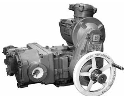
Электроприводы типа «Б» изготавливаются в общепромышленном и взрывозащищенном исполнении. Имеют крутящий момент на выходном валу от 100 до 300 Нм. Применяются для комплектации трубопроводной арматуры с условным проходом от 25 до 300 мм. Присоединительный фланец выполнен по СТ ЦКБА 062-2009 в исполнении «Б».
