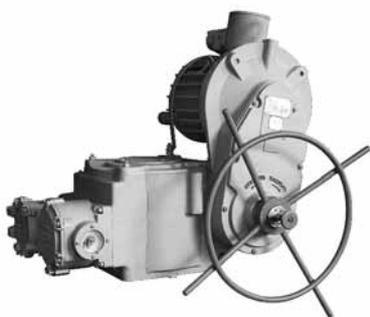
Электроприводы типа «Г» изготавливаются в общепромышленном и взрывозащищенном исполнении. Имеют крутящий момент на выходном валу от 600 до 2500 Нм. Применяются для комплектации трубопроводной арматуры с условным проходом от 250 до 1400 мм. Присоединительный фланец выполнен по СТ ЦКБА 062-2009 в исполнении «Г».
