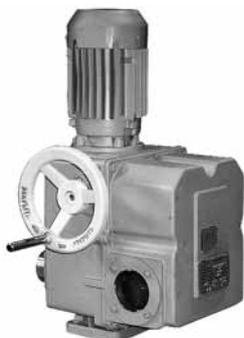
Электроприводы типа «А» изготавливаются в общепромышленном и взрывозащищенном исполнении. Имеют крутящий момент на выходном валу от 25 до 100 Нм. Применяются для комплектации трубопроводной арматуры с условным проходом от 10 до 150 мм. Присоединительный фланец выполнен по СТ ЦКБА 062-2009 в исполнении «А», может быть изготовлен с кулачками или квадратом для присоединения к арматуре.
