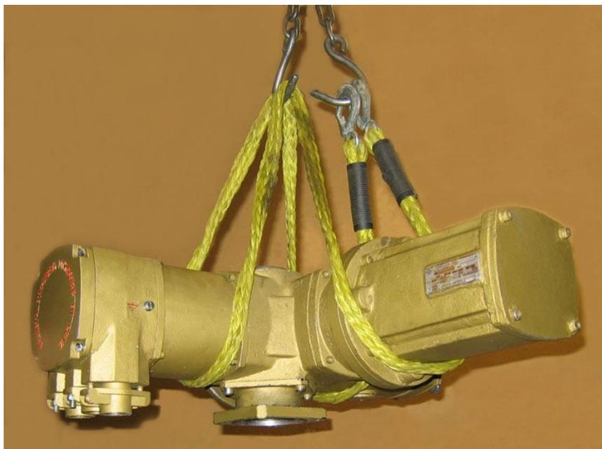
Рисунок 5 – Монтаж привода на арматуру
