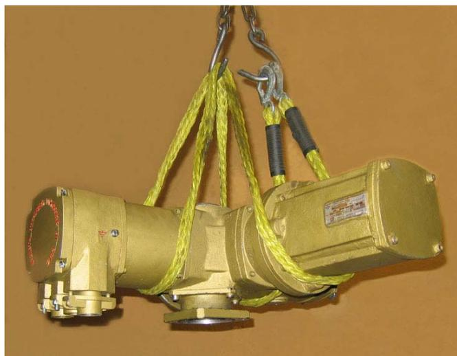
Рисунок 4 – Монтаж привода на арматуру
