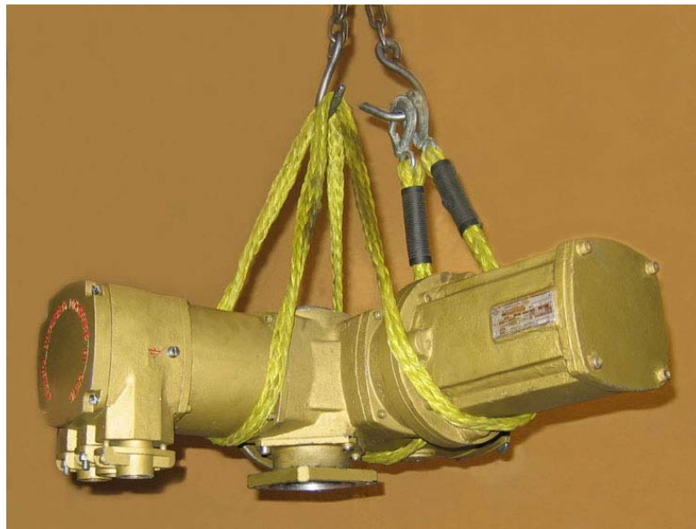
Рисунок 4 – Монтаж привода на арматуру
